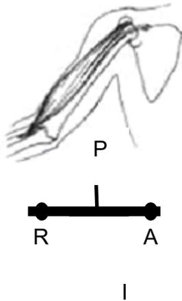
En el movimiento del brazo, el hombro funciona como el punto de apoyo (A), la potencia (P) o fuerza la da el músculo del bíceps mientras que la resistencia (R) está en los objetos que se levantan.
